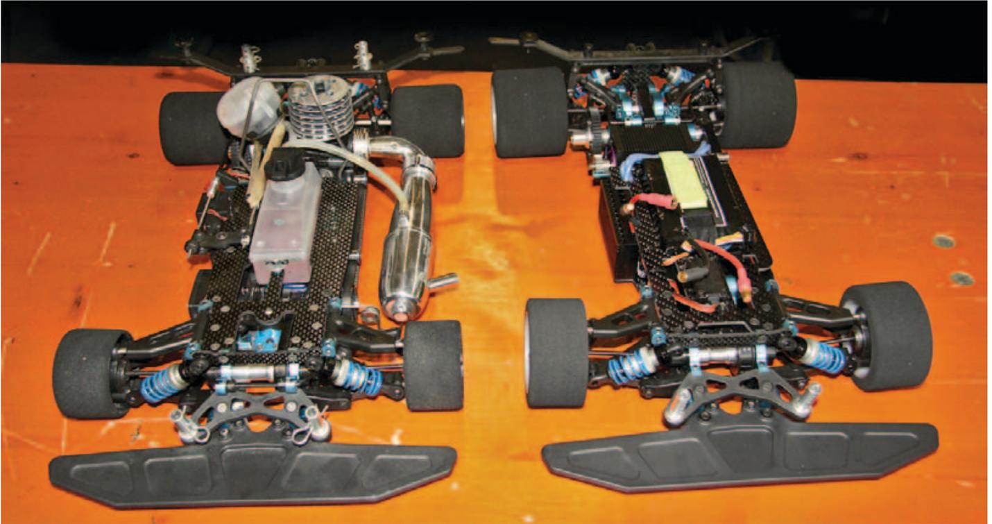
Zwei mal Velox 8, links die Nitro-, rechts die neue Elektroversion E8.
